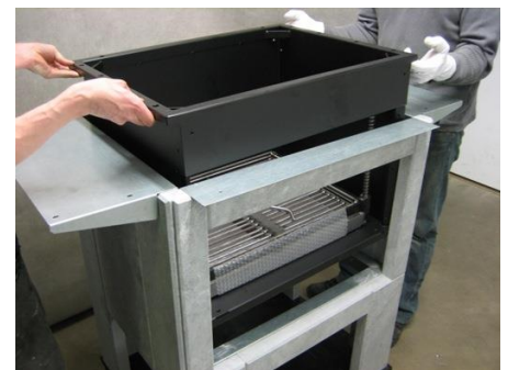
12. Nosta grillisydän yläkautta grillin sisään
