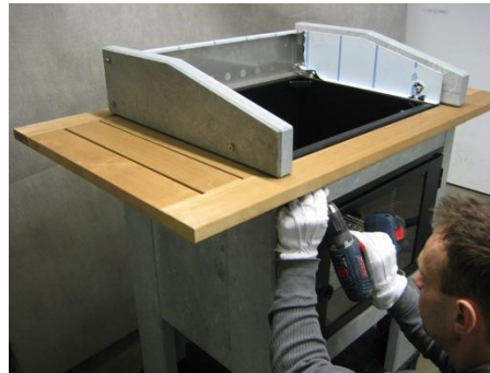
17. Keskitä työtaso ja kiinnitä edestä ja takaa puuruuveilla
