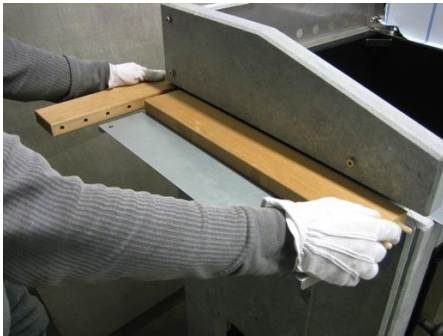
16. Aseta työtason osat kuvan mukaisesti paikoilleen
